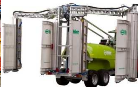
WEBER – descentes avec panneaux récupérateurs
