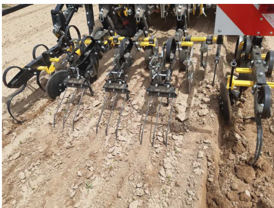
Bineuse de petits légumes équipée d'une interface de guidage et d'une camera. (Photo CA BZH)
