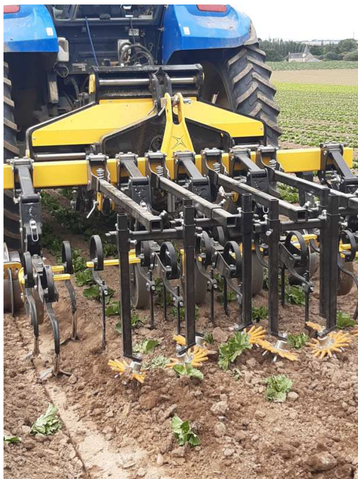
Binage des salades avec bineuse étoile et interface de guidage de la bineuse par contrôle camera. Guidage GPS du tracteur.
