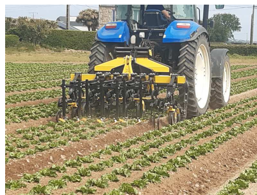
Interface de guidage + camera montée sur bineuse Hazenbichler (Photo CA BZH)
