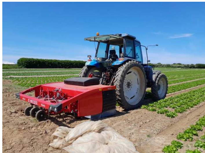
Le binage des légumes sur le rang se perfectionne Bineuse-camera Lemken. (Photo : Démonstration de binage le 4/05, Sibiril)
