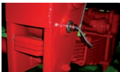
Capteur d'effort monté sur l'axe de suspension
