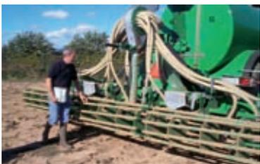
Broyeur répartiteur à axe horizontal sur enfouisseur 7,40 m
