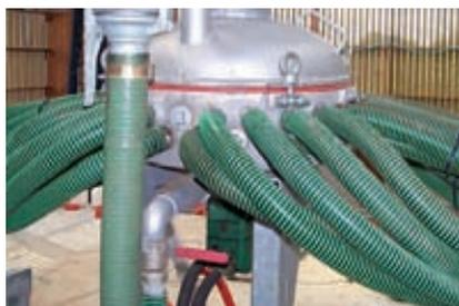
Broyeur répartiteur à axe vertical. L'appareil est placé très haut, l'entretien est moins facile
