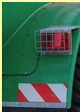
\* Panneau rétro-réfléchissants rouge et blanc respectant la norme TPESC. Dimensions possibles : 423 x 423 mm, 423 x 282 mm ou 140 x 1140 mm.
