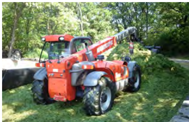
Confection du silo d'ensilage suite au déchargement et tassement du fourrage dans un silo couloir.
