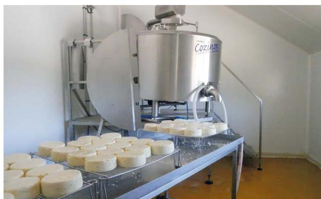
Moulage par gravité directement sur les tables grâce à une cuve fromagère de 650 litres placée en hauteur.
