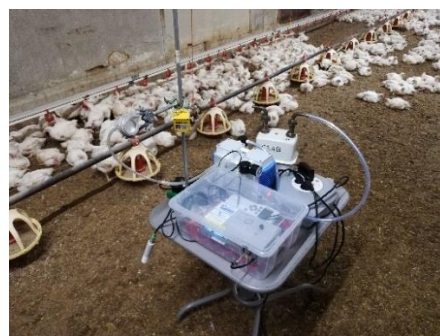
Figure 2 : Dispositif expérimental de mesure des particules dans le bâtiment
