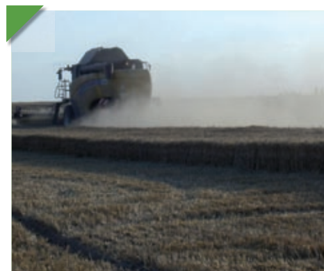
La moissonneuse peut s'adapter à la récolte des menues pailles.
