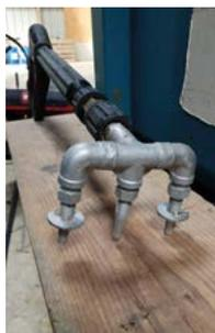
Trois jets d'eau à haute pression facilite le nettoyage.
