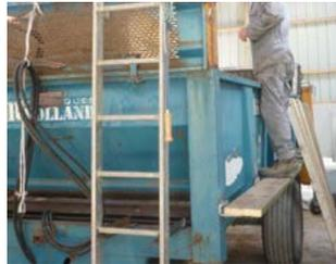
Une planche fixée à bonne hauteur permet à l'éleveur de couper les ficelles des ballots sans monter dans l'épandeur.
