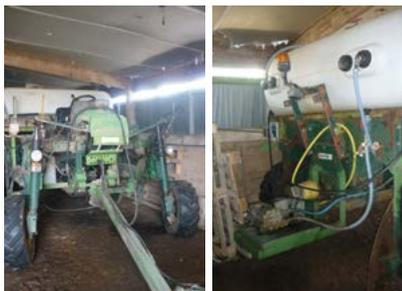
La pompe haute pression est intégrée à l'arrière de l'automoteur.
