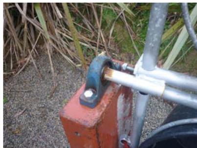
Roulement permettant le basculement du porte-seaux.
