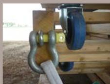
Sangles de traction attachées aux anneaux qui permettent de tracter le chariot.
