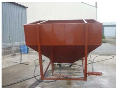
Une barre métallique à l'avant de la trémie permet de disposer le rouleau de papier.
