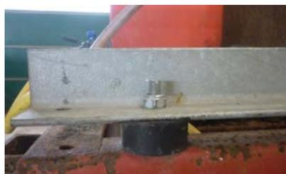
*Les amortisseurs en caoutchouc permettent d'éviter les vibrations de la pompe.*
