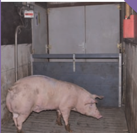
Une bascule disposée sur le circuit des animaux permet de les peser et de les trier.
