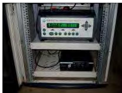
**L'analyseur de gaz permet de mesurer cinq gaz différents**
