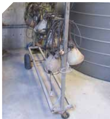
La roue pivotante à l'avant permet au châssis de tourner facilement à 360° dans les couloirs des bâtiments
