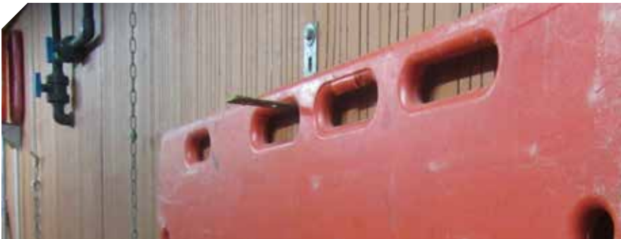
Des crochets fixés au mur permettent de ranger les panneaux
