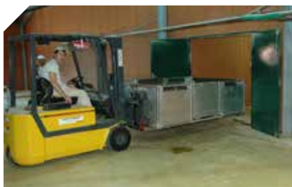
Des fourches peseuses facilitent la pesée des porcelets
