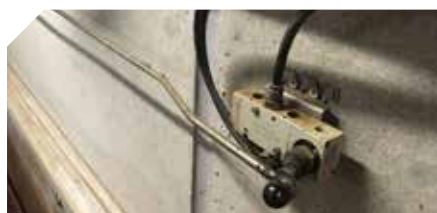
Le système d'ouverture pneumatique des portes facilite le travail
