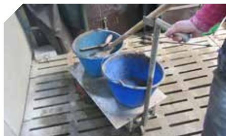
La poignée facilite le déplacement du chariot
