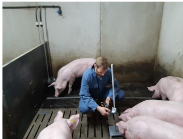
Figure 3 : Mesure de l'éclairage à l'aide du luxmètre en présence des porcs. Un support gradué permet d'assurer la hauteur de la mesure par rapport au sol.
