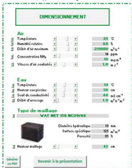
Figure 3 : données à compléter dans le module dimensionnement (extrait de l'outil TARA)
