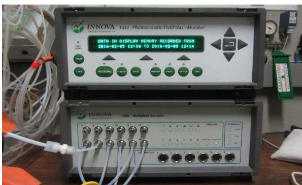
Analyseur de gaz photo-acoustique à infrarouge INNOVA
