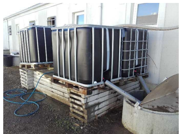
Système mis en place pour prélever et volumer le lisier des salles expérimentales de la station de Crecom
