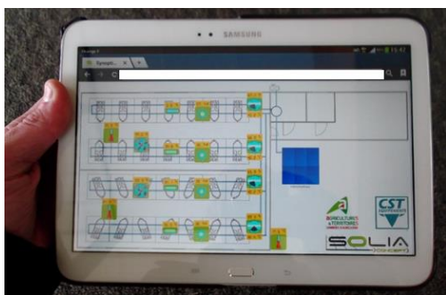
Photo 9 – Logiciel de supervision sur tablette
