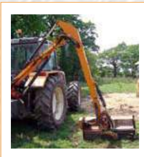
Débroussaillage avec épareuse
