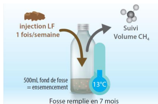
Figure 2 : Schéma du dispositif expérimental : utilisation de bouteilles de 1 litre, à 13°C
