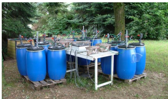
Photo 1 : Dispositif expérimental : suivi de production en extérieur, en bidons de 200 litres
