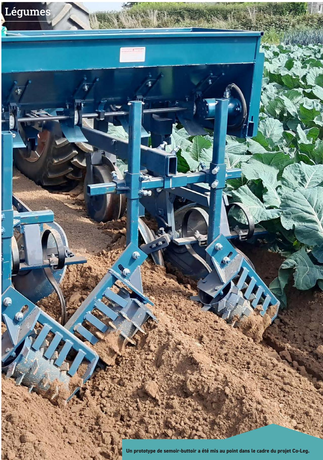
Un prototype de semoir-buttoir a été mis au point dans le cadre du projet Co-Leg.
