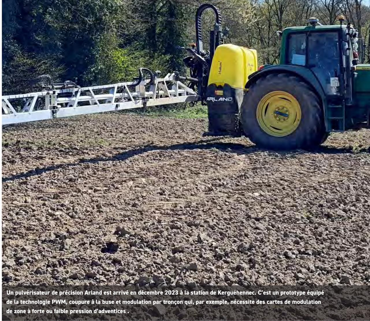
Un pulvérisateur de précision Arland est arrivé en décembre 2023 à la station de Kerguéhennec. C'est un prototype équipé de la technologie PWM, coupe à la buse et modulation par tronçon qui, par exemple, nécessite des cartes de modulation de zone à forte ou faible pression d'adventices .
