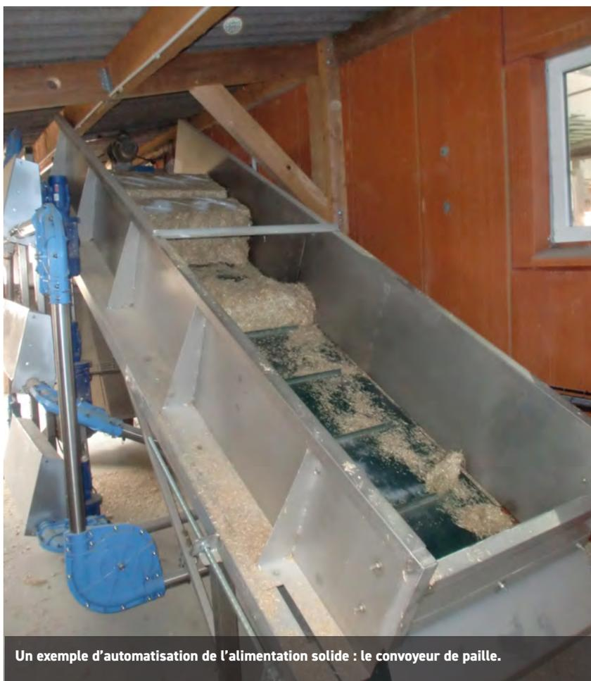
Un exemple d'automatisation de l'alimentation solide : le convoyeur de paille.
